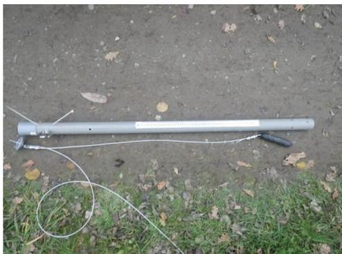
Sonde HOBO U20, avant sa mise en place dans le puit de mesure
